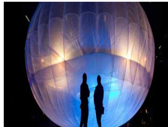
구글 룬 프로젝트, 2015.10.29, 2017.10.07 since 2013 구글이 '16년 인도네시아 이동통신사 3곳과 함께 열기구 통신망 실험을 계획, 오지에 있는 인도네시아인 1억명이 인터넷을 사용할 수 있도록 함이 목적, 풍선지름 15m 상공 20km 높이에서 반경 40Km에 서비스 제공, 187일 체공 푸에르토리코 응급이동전화서비스 제공목적 실험국허가
